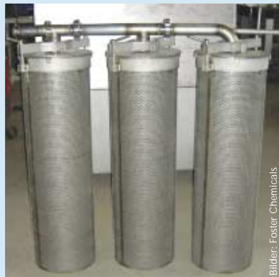
Neun solcher Filterkerzen mit Filtersäcken aus Polypropylen befinden sich in einem Filtermodul
