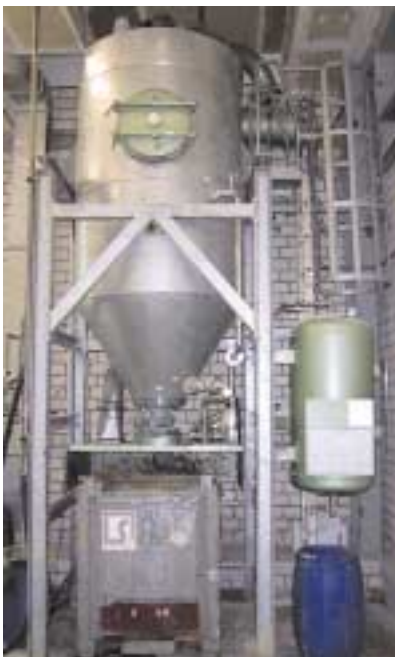
Die Destillationsanlage bei Foster Chemicals. Hier werden die verschmutzten Entlackungsbäder von Lackschlamm und gelösten Bindemitteln befreit.
