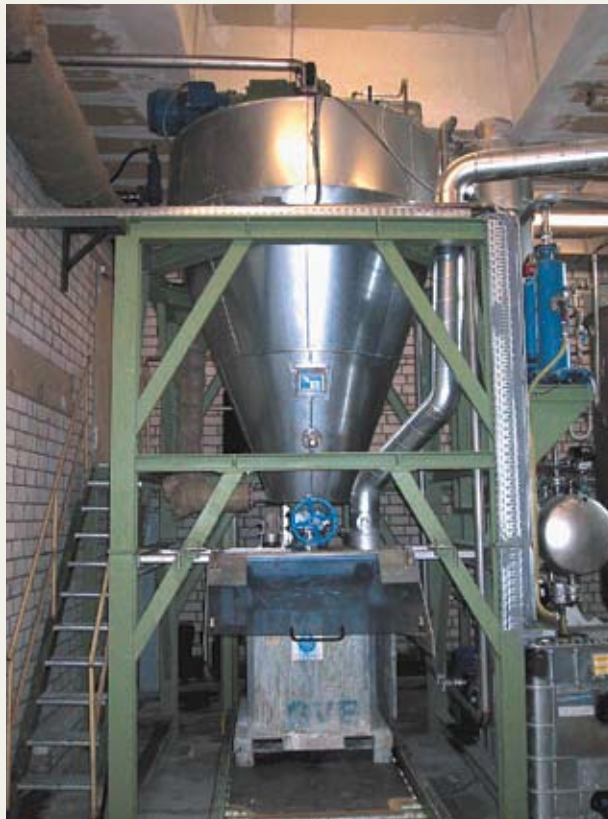
Durch Destillation in einer leistungsstarken Recyclinganlage werden die Lösemittel aus verschmutzten, lösemittelhaltigen Entlackern und Schlämmen zurückgewonnen
