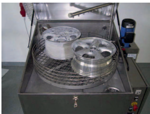
Entlackung von Felgen in einer Spritzentlackungsanlage
