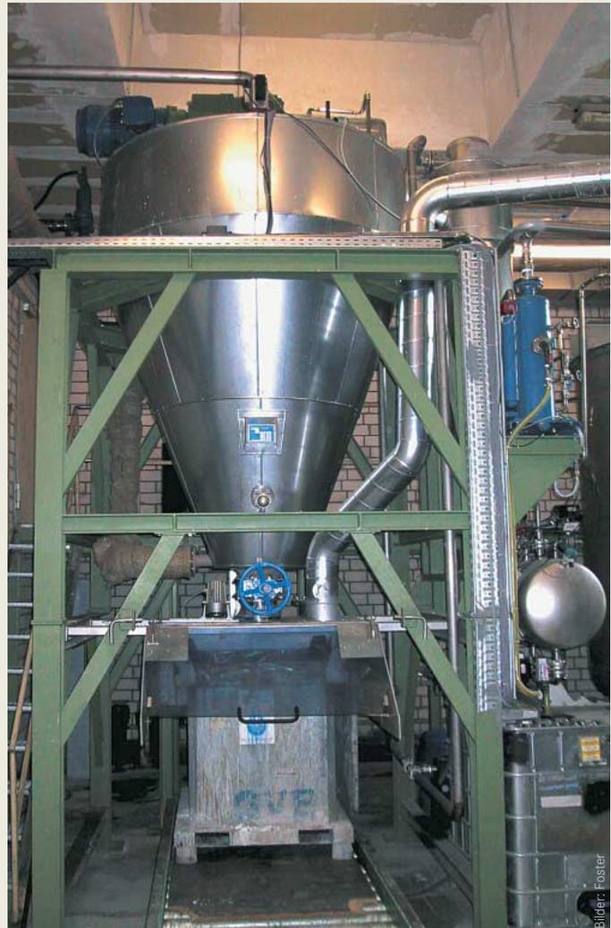
▲ Die neue Destillationsanlage zur Aufbereitung verschmutzter Lösungsmittel
