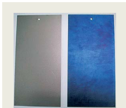
Stahlbleche vor (links) und nach der Phosphatierung
