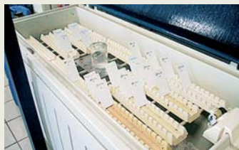
Die neue Phosphatierung bietet eine ausgezeichnete Korrosionsbeständigkeit. Im Salzsprühtest nach DIN 50021 SS wurden auf lackierten Stahlblechen Werte von bis zu 450 Stunden und mit Nachpassivierung bis 850 Stunden erreicht.
