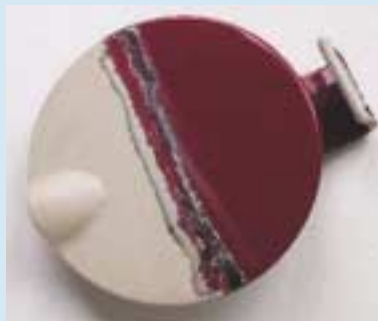
Fehllackierte Kunststoffteile sind nicht mehr unbedingt Ausschuss, sondern können durch Entlackung wieder in den Produktionskreislauf zurückgeführt werden. Beispielhaft hier ein lackierter Tankdeckel aus Kunststoff vor (links) und nach (rechts) der Entlackung. Deutlich erkennbar sind nach der partiellen Entlackung die verschiedenen Lackschichten.
