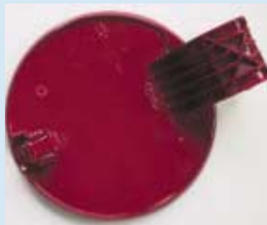
Fehllackierte Kunststoffteile sind nicht mehr unbedingt Ausschuss, sondern können durch Entlackung wieder in den Produktionskreislauf zurückgeführt werden. Beispielhaft hier ein lackierter Tankdeckel aus Kunststoff vor (links) und nach (rechts) der Entlackung. Deutlich erkennbar sind nach der partiellen Entlackung die verschiedenen Lackschichten.
