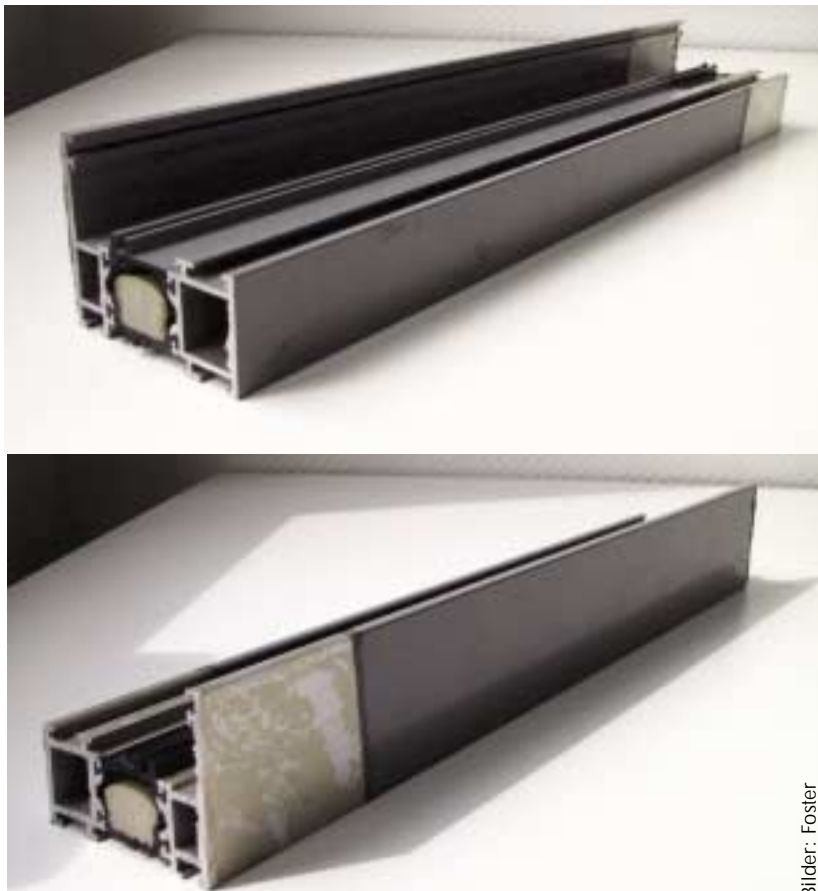
Lackiertes Fensterprofil aus Aluminium vor (oben) und nach (unten) der Entlackung. Im mittleren Hohlraum sieht man deutlich den Polyurethanschaum, der bei der Entlackung nicht angegriffen wurde.
